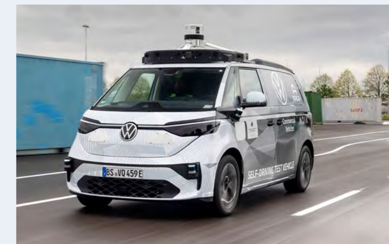
아르고AI의 장거리 라이다를 장착한 폭스바겐 도심용 자율주행차량 ID. Buzz AD, 출처:VW
